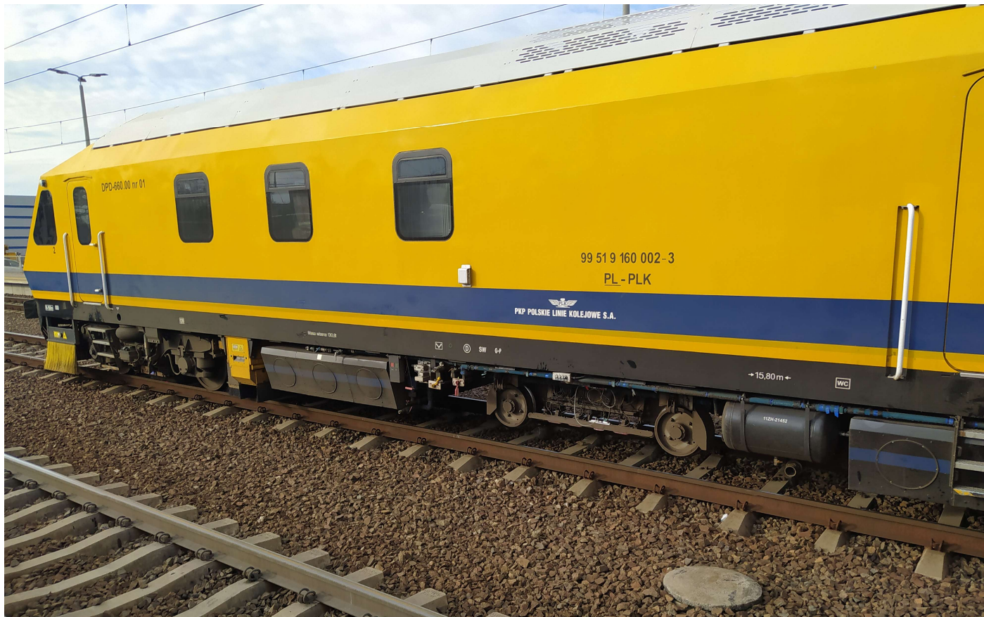
Rys.1. Drezyna pomiarowa PKP PLK typ DPD-660 i wózek ręczny do badań ultradźwiękowych szyn kolejowych
