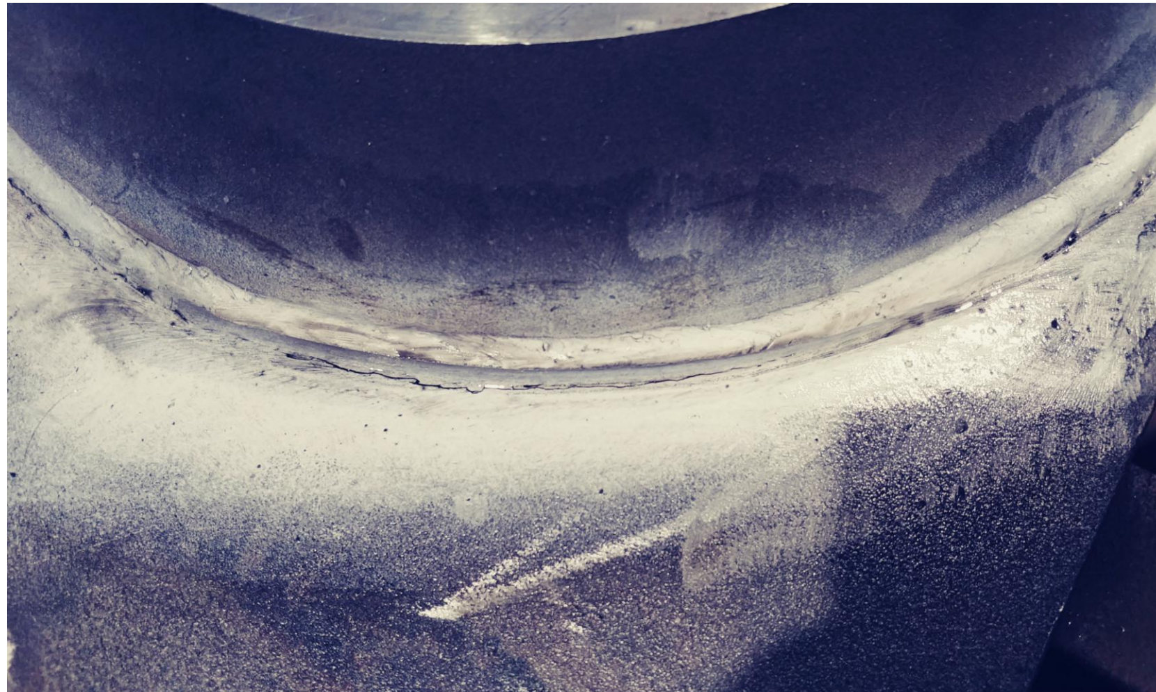
Badanie MT czop skrzytu metoda barwna
