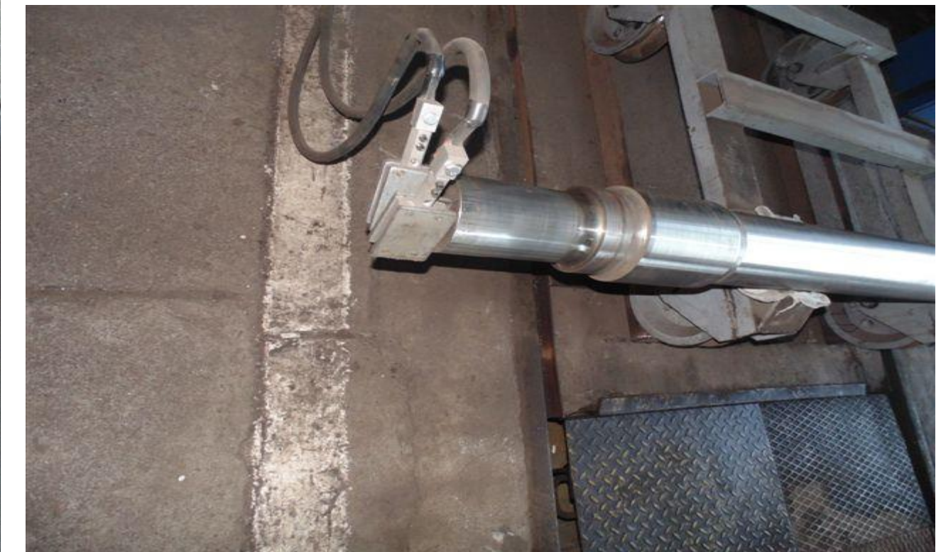
Elektrody (zaciski magnetyczne) na wady wzdłużne
