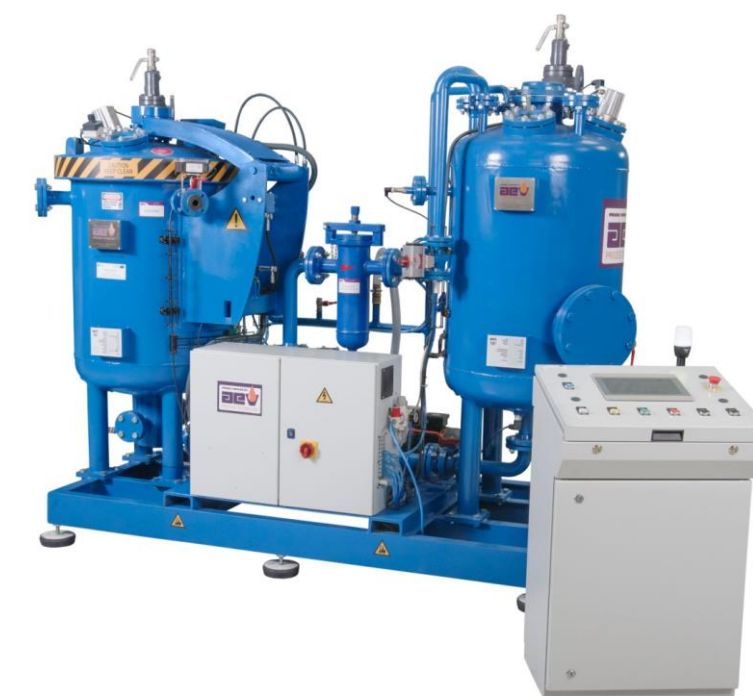
Nasączenie i utwardzanie rdzeni
