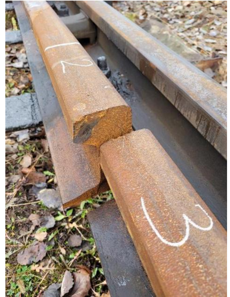
Fot. 2. Widok pękniętej iglicy/szyny rozjazdu. Odcinek próbny nr 2 i 3.
