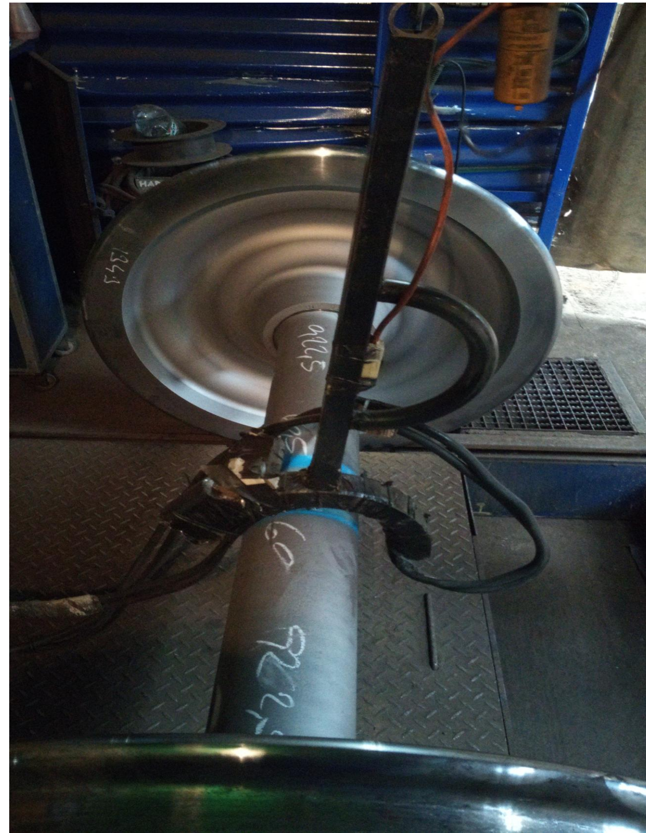
Elektrody (zaciski magnetyczne) na wady wzdłużne
