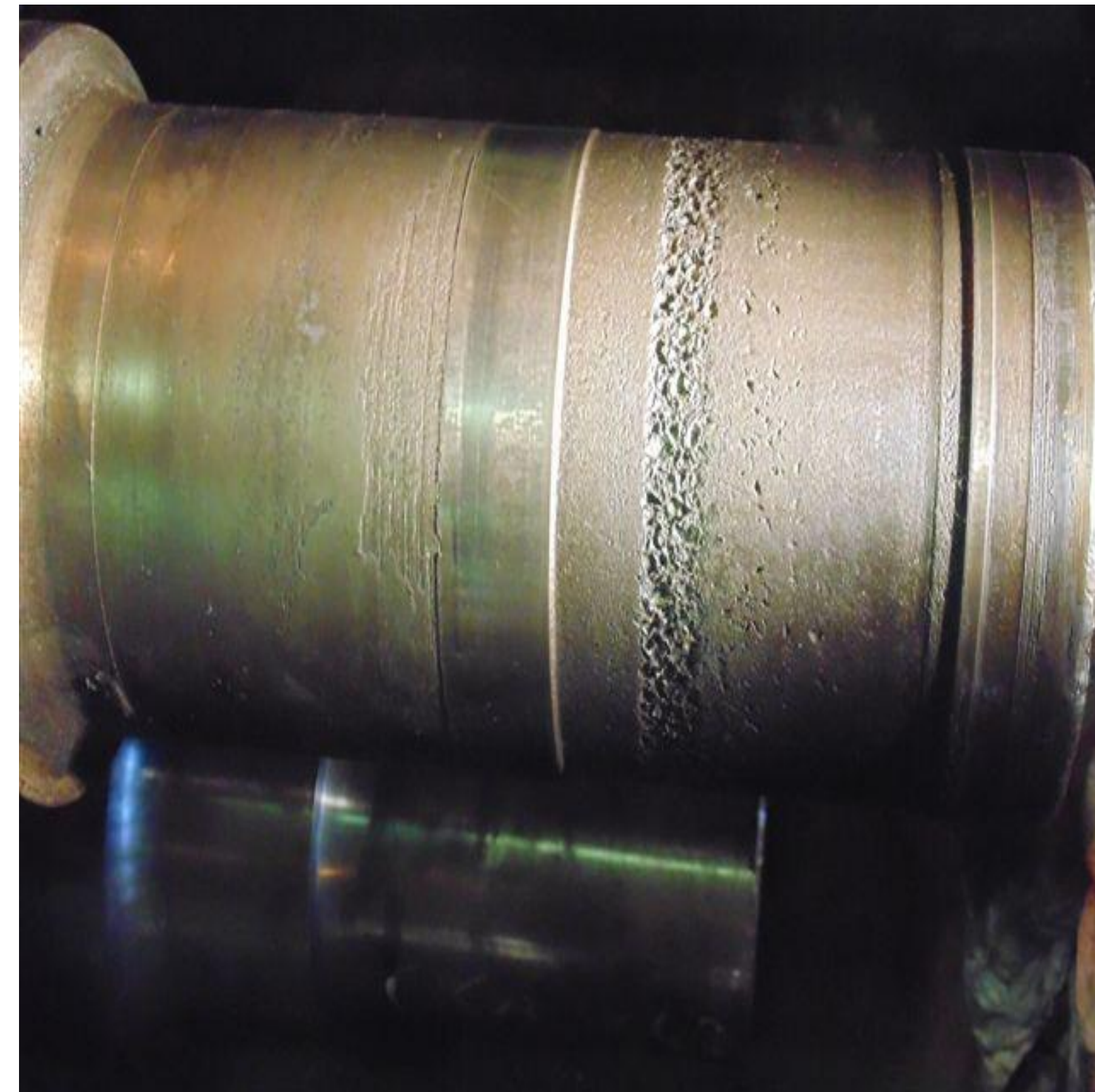
Uszkodzony czop wytarcie na średnicy od strony zewnętrznej
