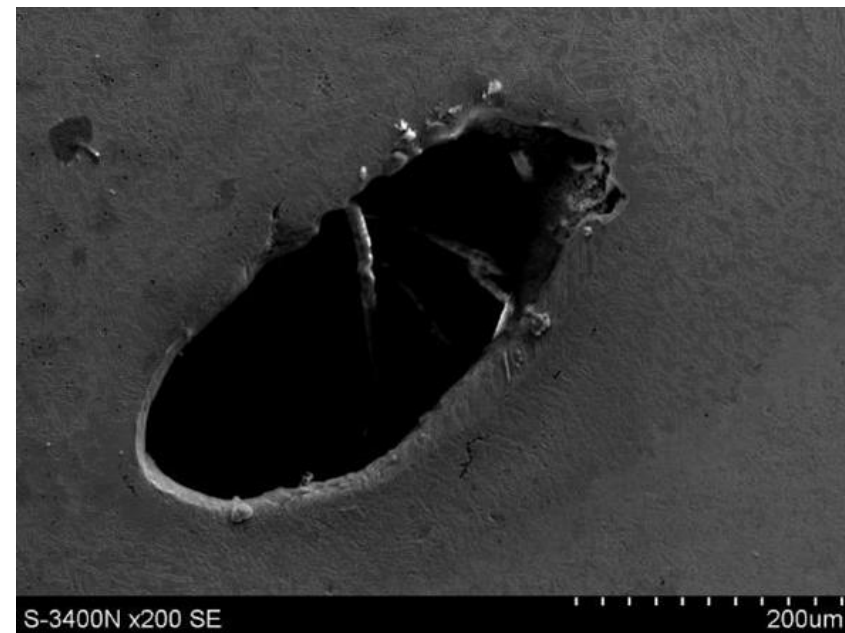
Fot.2 Próbk nr 2 – pustka w napoinie
