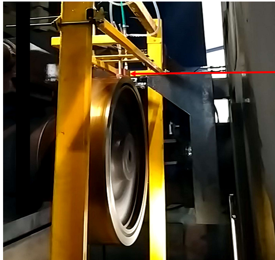
Rys.3. Stanowisko do badań wpływu zmian parametrów pracy układu blok przetworników (BP) na parametry użytecznego sygnału ultradźwiękowego
